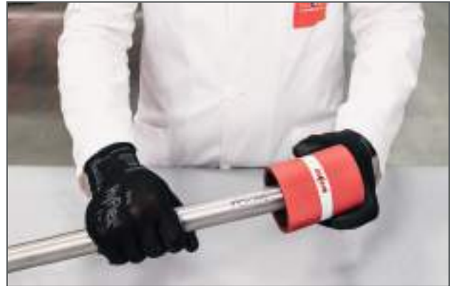
Sbavatura del tubo / Deburring the pipe
